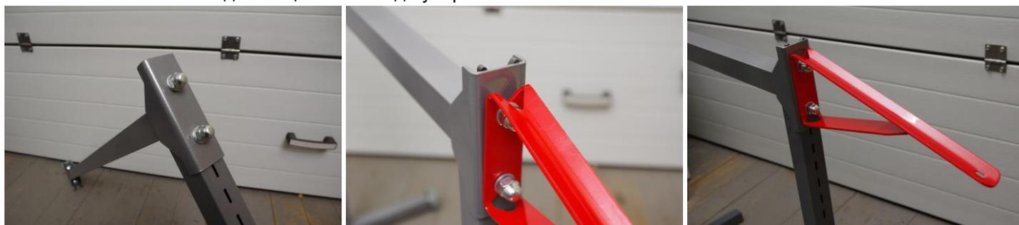
**4 – Монтируем Несущие вертикальные стойки:** вставляем Несущую вертикальную стойку в соединяющую часть Перекладки таким образом, чтобы стенка вертикали прошла между Закладной пластиной и стенкой соединяющей части – до упора. **Затягиваем Колпачковые гайки.**
